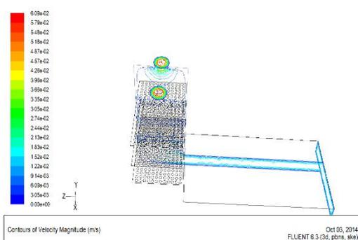
شکل (۹) - بررسی عددی اندازه سرعت در خشک‌کن خورشیدی کلینتی نوع دوم در حضور صفحه عمود بر محور X
