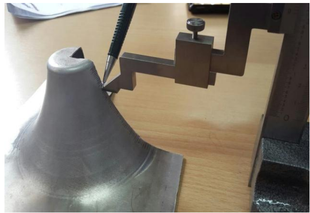
شکل ۸- نحوه اندازه گیری عمق و ضخامت نقاط
