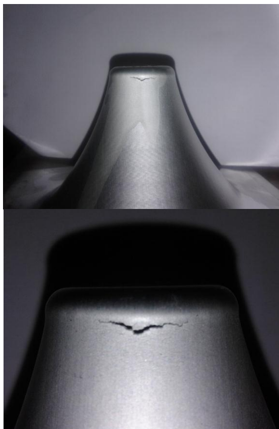
شکل ۷- شکست در ورق پس از اتمام شکل دهی
