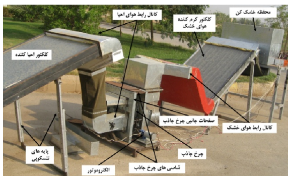
شکل (۳): نمای کلی خشک‌کن خورشیدی با ماده جاذب رطوبت
