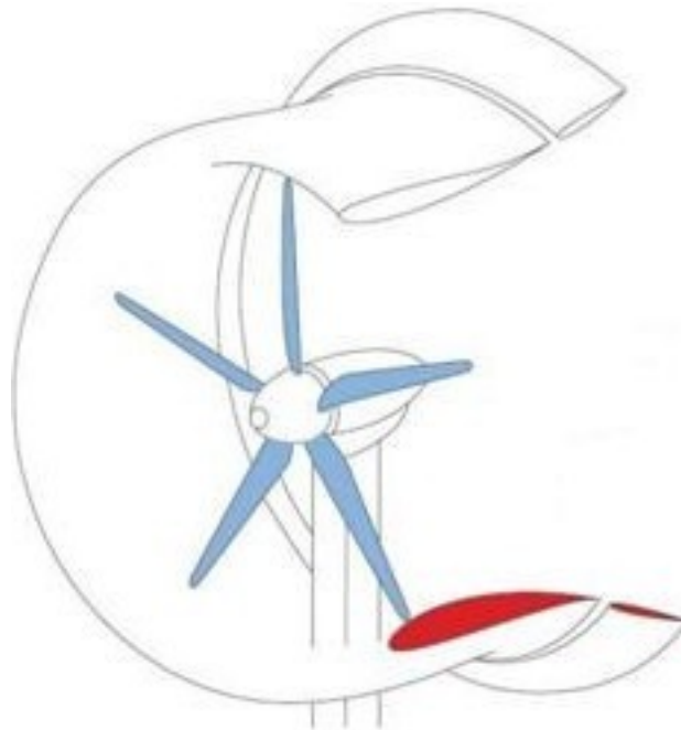
شکل ۲ - پوسته ی برش خورده ی یک توربین باد کوچک
