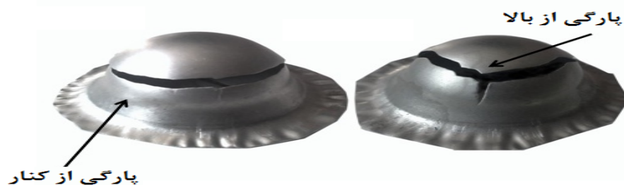
شکل ۵: پارگی در منطقه شعاع سرسنبه
