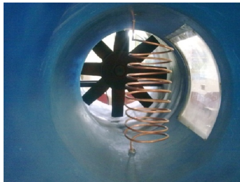
شکل (۳): نمایی از لوله ماریچ در تونل باد
