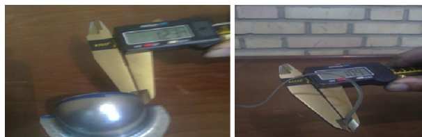
شکل ۱۲: نمونه برش خورده با وایرکات
