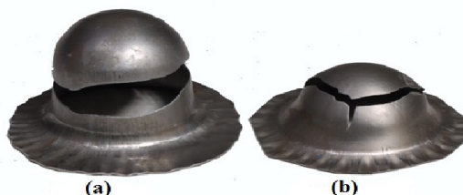
شکل ۱۴: نمونه‌های از پارگی به وجود آمده (a) کشش عمیق سستی (b) کشش عمیق هیدرومکانیکی
