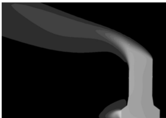
شکل (۶): طیف دما در سطح تقارن برج با دهانه خروجی مایل
